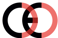
Marcatura CE contraffatta (troppo vicino)
